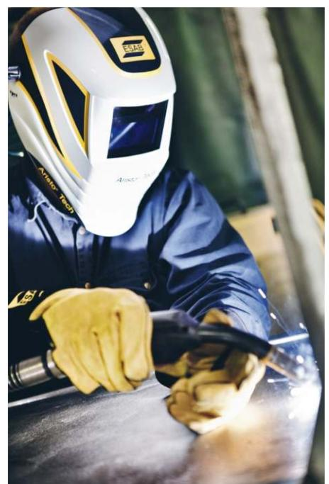
*Aristo Tech* skydelis atitinka CE, ANSI, AS/NZS ir CSA standartus. Skydelio apsauginiam filtrui panaudota skaitmeninė technologija su vidiniu LCD ekraneliu ir preciziška tamsejimo kontrole (DIN 5-13), 8 jautrumo lygiai, uždelsimas 0,1-3,5 s. Tamsumo ir jautrumo reguliavimo pultas sumontuotas skydelio išorėje, todėl ji lengva reguliuoti net dėvint pirštines.
