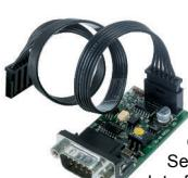
**Interfaccia seriale RS232, permette la connessione con una stampante seriale o un personal computer.**
