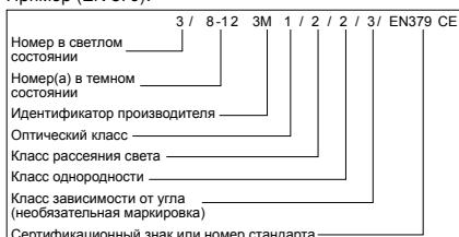
**Внимание!** Выше приведен пример. Сварочный светофильтр маркируется определенной классификацией. 3M 1BT (EN166 удар средней энергии при экстремальных температурах (-5°C и +55°C) BT) 3M EN175B (удар средней энергии В).
