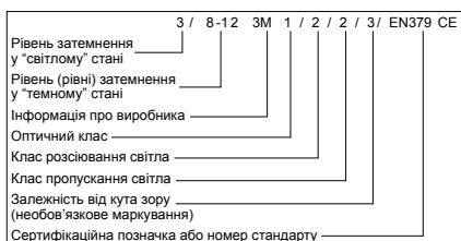
**Увага!** Наведене вище є тільки прикладом. Реальне маркування нанесено на встановленому в щитку фільтрі автоматичного затемнення.
