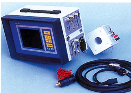
5 pav. QAS 400 aparatas su asmeniniu kompiuteriu, skirtas mechanizuotam/orbitiniui TIG suvirinimui. Jame yra specialūs apsauginiai davikliai (su skaitmeniniu ir analoginiu jėjimu), kontroluojantys ir registruojantys iki 5 parametry. Pavyzdis iš A/S ESAB/HKS Prozesstechnik GmbH.
