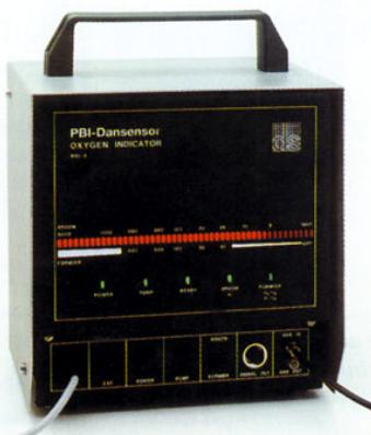
6 pav. Aparatas deguonies koncentracijos indikacijai. Veikia keraminio daviklio pagrindu, diapazonas 1-5 000 ppm O<sub>2</sub> argono dujose ir 10-500 ppm 90/10 N<sub>2</sub>/H<sub>2</sub> dujose. Pavyzdis iš PBI Dan-sensor.
