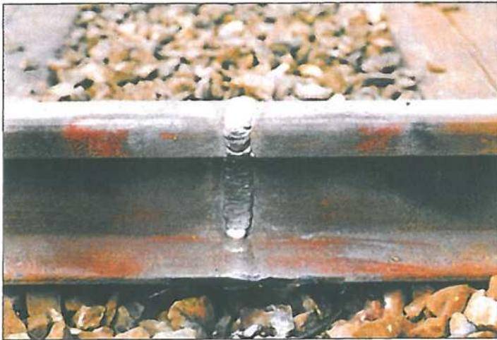
Bėgių sujungimas, naudojant elektrodus OK 83.28 ir OK 74.78 bei keraminį padékliuką OK Backing 21.21.
