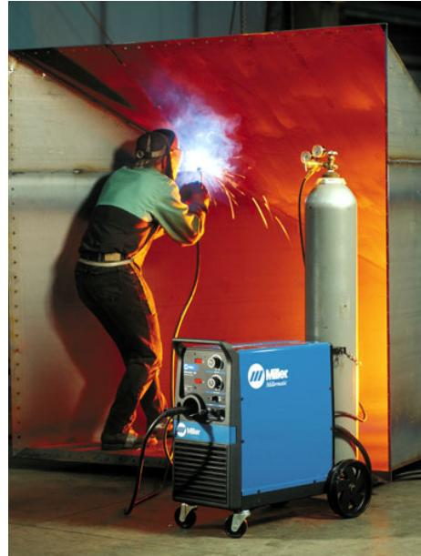
Suvirinant MIG būdu naudojama elektrodinė viela ir atskirai dujos lankui suformuoti bei suvirinimo voniai apsaugoti. Apsauginės dujos paprastai būna CO<sub>2</sub> arba argono-O<sub>2</sub>-CO<sub>2</sub> mišinys, kartais dalį argono gali pakeisti helis. Susidarančiam suvirinimo dūmų kiekiui įtakos turi suvirinimo režimo parametrai bei skysto metalo pernešimo būdas.
