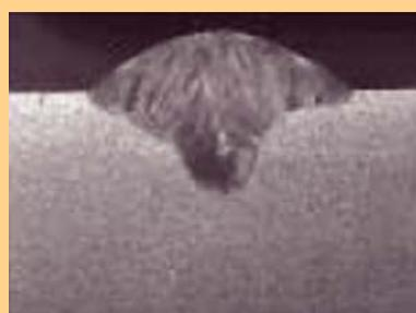
1 pav. 1.4301/304 plieno MAG suvirinimas, pilnai mechanizuotas, vielos skersmuo Ø 1,2 mm, vielos padavimo greitis 9,4 m/min, PA padėtis. Ar + 2,5% CO<sub>2</sub>, pavaizduota kairėje pusėje, Ar + 2% CO<sub>2</sub> + 20% He, pavaizduota dešinėje pusėje.
