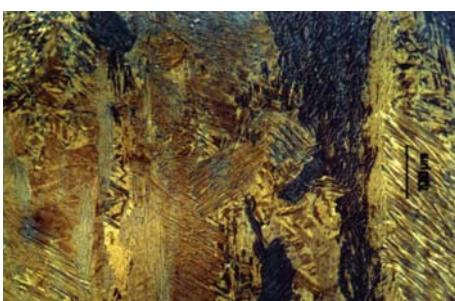
**7 pav.** Tipinė mikrostruktūra metalo, prilydyto panaudojant vielą su supermartensitinės struktūros metaliniu užpildu OK Tubrod 15.55 (<0,01% C, 12% Cr, 6,5% Ni, 2,5% Mo).
