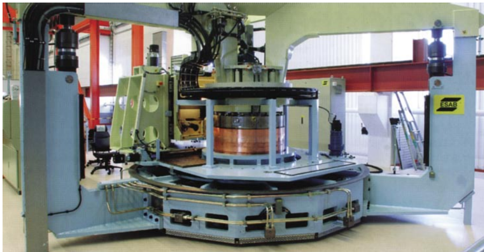
4 pav. Suvirinimo aparatas talpyklų gamybos laboratorijoje.
