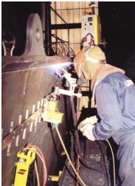
6 pav. Portalo keliomojo krano pagrindinės atramos suvirinimas horizontalioje padėtyje. Panaudojamas Railtrac ir elektrodinė viela PZ6105R.
