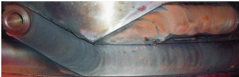
5 pav. Suvirinimo pradžia ir išėjimo skylė virš sujungimo linijos.
