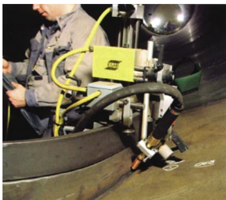
7 pav. FrameTrac, pritaikytas durų rėmams suvirinti.
