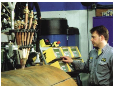
2 pav. Bendras suvirinimo po fliusu, naudojant sistemą iki 6 vielų, vaizdas.
